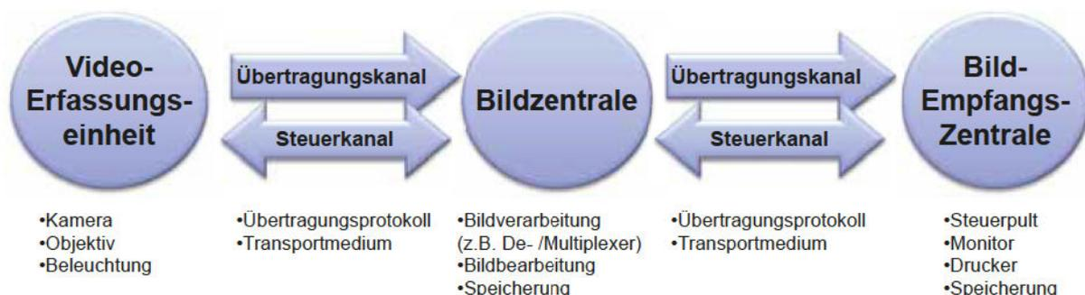
**Bild 14-1:** Schema einer Videoüberwachungsanlage
