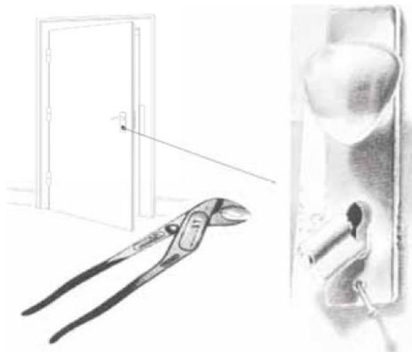
**Bild 6-6:** Schwachpunkt Schließzylinder
