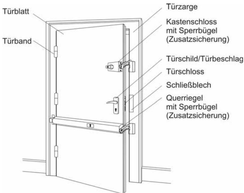
**Bild 6-1:** Bestandteile einer Tür (sog. Drehtür) mit Zusatzsicherungen
